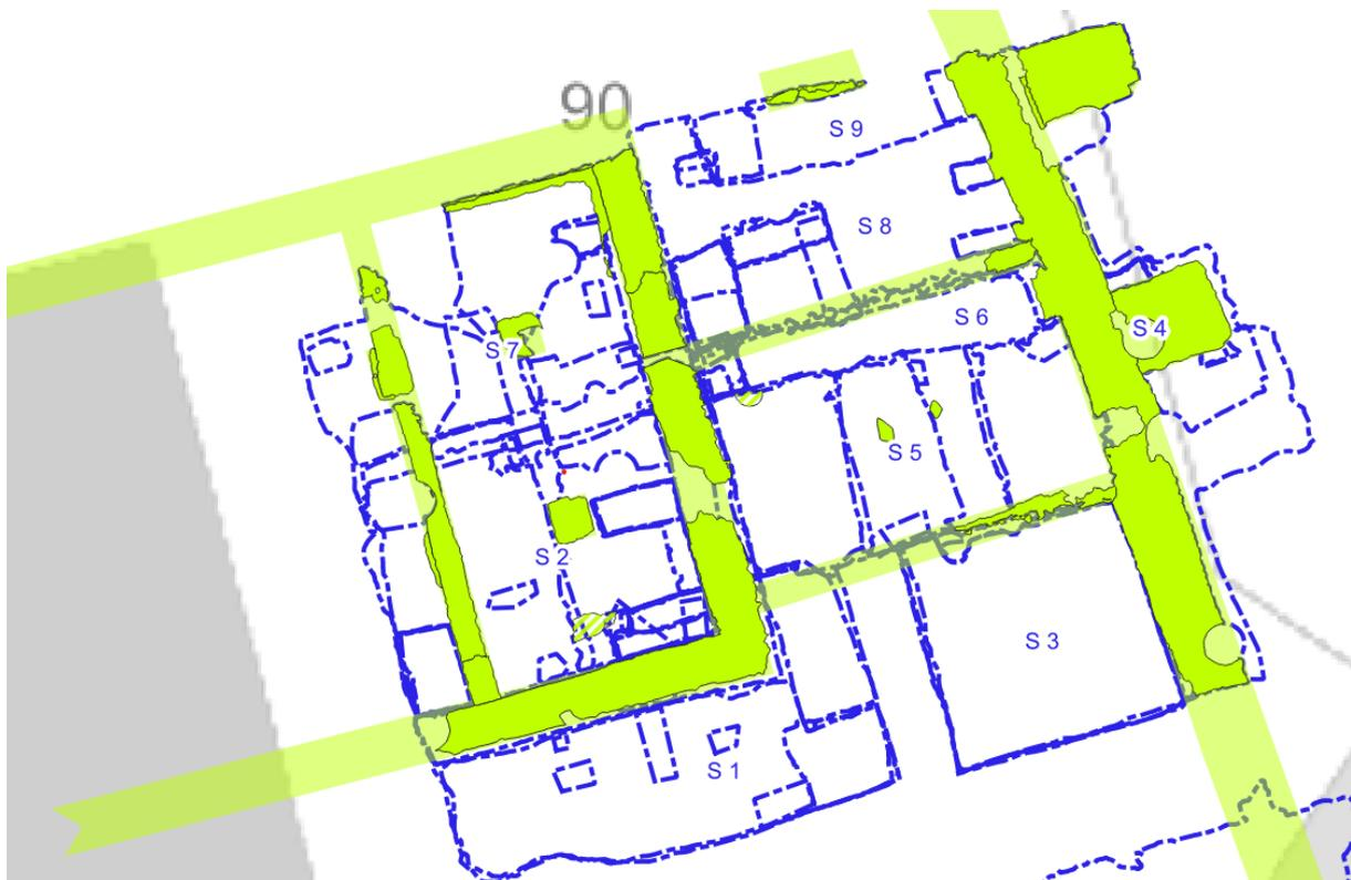
Abb. 21 Bad Waldsee, Hauptstr. 10-12. Ausschnitt Bauphasenplan FNZ I. Vollfarbig: Befund, Transparent: Rekonstruktion
